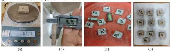
Figura 10 - Ensaios mecânicos no painel de flecha de sisal
