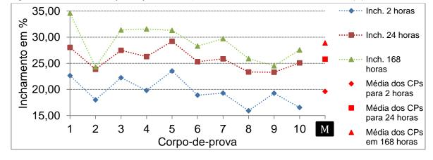
Figura 11 - Inchamento do painel para 2 horas, 24 horas e 168 horas e valores médios (M)
