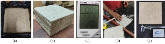
Figura 9 - Ensaios físicos no painel de flecha de sisal
