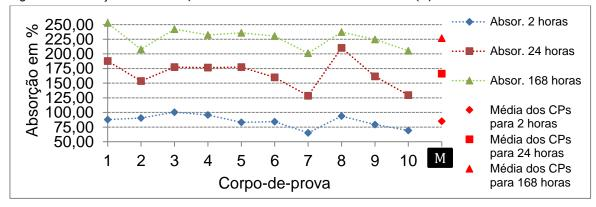
Figura 12 - Absorção em 2 horas, 24 horas e 168 horas e valores médios (M)
