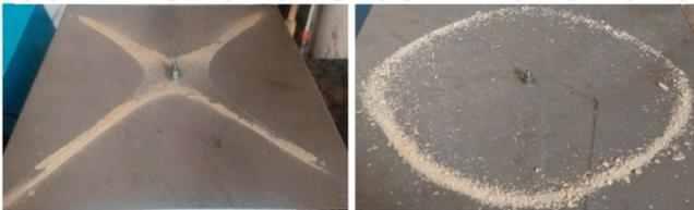
**Figura 2:** Combinação dos modos  $(2,0)$  e  $(0,2)$  observados em uma placa metálica.
